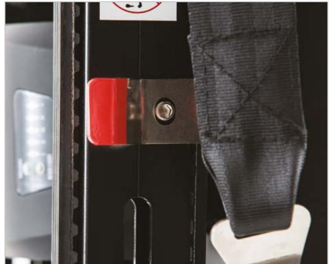
■ Sistema di sblocco ancoraggio cingoli
